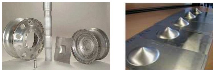
Figure 3: Ejemplos de productos obtenidos por conformado electromagnético. Fotos adquiridas en http://www.iap.com/magnetic-compaction.html y en http://www.amire.net/labeinweb .
